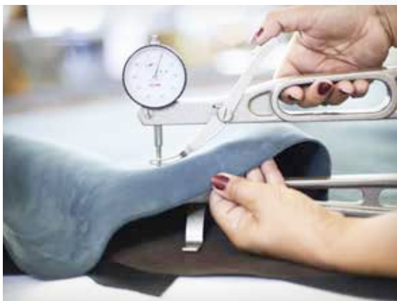
Mesure de l'épaisseur du cuir dans les ateliers Lemaitre Measuring the thickness of the leather in Lemaitre workshops
